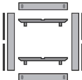
Zuerst dreht man die Gewindestäbe in die Seitenteile und steckt die dickeren (10 mm) Dübel in die dafür vorgesehenen Bohrungen. Anschließend verbindet man so die Seitenteile mit den Quertraversen und dem Kopf- und dem Fußteil. Drehen sie nun auf die Gewindestäbe eine Mutter (M8) mit Unterlegscheibe. Ziehen Sie die Verbindung mit dem beiliegenden Maulschlüssel stramm an. Arbeiten sie vorsichtig mit dem Maulschlüssel, damit im Arbeitsbereich keine Druckstellen auf Holzteilen entstehen.
