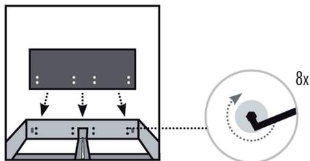
Stecken Sie nun die Rückenlehne auf die Gewindestäbe und schrauben Sie diese beidseitig mit den Hülsenmuttern fest.
