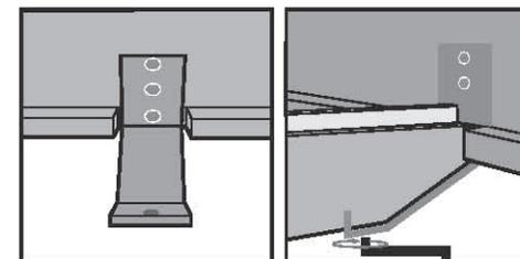
Anschließend stecken Sie die Auflageleisten für den Lattenrost in die entsprechenden Bohrungen an den Seitenteilen.
