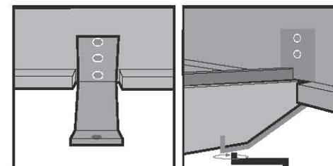
Befestigen Sie die Auflageleisten an den Seitenteilen des Bettrahmens. Schlagen Sie mit einem Gummihammer die kurzen Holzdübel vorsichtig in die Bohrungen der vier Auflageleisten für den Lattenrost. Je Auflageleiste benötigen Sie vier Dübel, falls sich diese nicht schon in der Leiste befinden.
