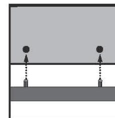
Stecken Sie die Auflageleisten mit den Holzdübeln in die hierfür vorgesehenen Bohrungen der Seitenteile. Sie haben hierbei die Möglichkeit zwischen zwei Lattenrostabsenkungen zu wählen. Im Zweifelsfall wählen Sie bitte die untere Bohrung.
