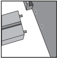
Anschließend schieben Sie bitte die Seitenteile mit den Öffnungen nach unten in die Füße. Der Rahmen muss sich mit leichtem Druck zusammenfügen lassen.
